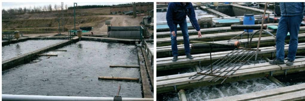
Obr. 11. Umístění podélných airliftů do nádrží (Dánsko) (foto: J. Mareš).
