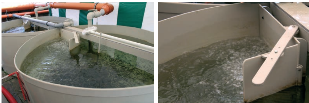
Obr. 12. Využití airliftu v plastových kruhových nádržích pro odchov mladých kategorií ryb (foto: J. Mareš).
